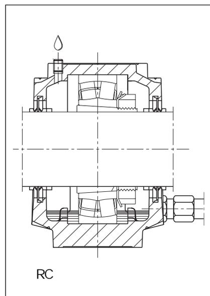
parte superior da caixa. Essas caixas podem ser fornecidas pela FCM a partir do tamanho SNH 511-609 adicionando-se o sufixo RC.
