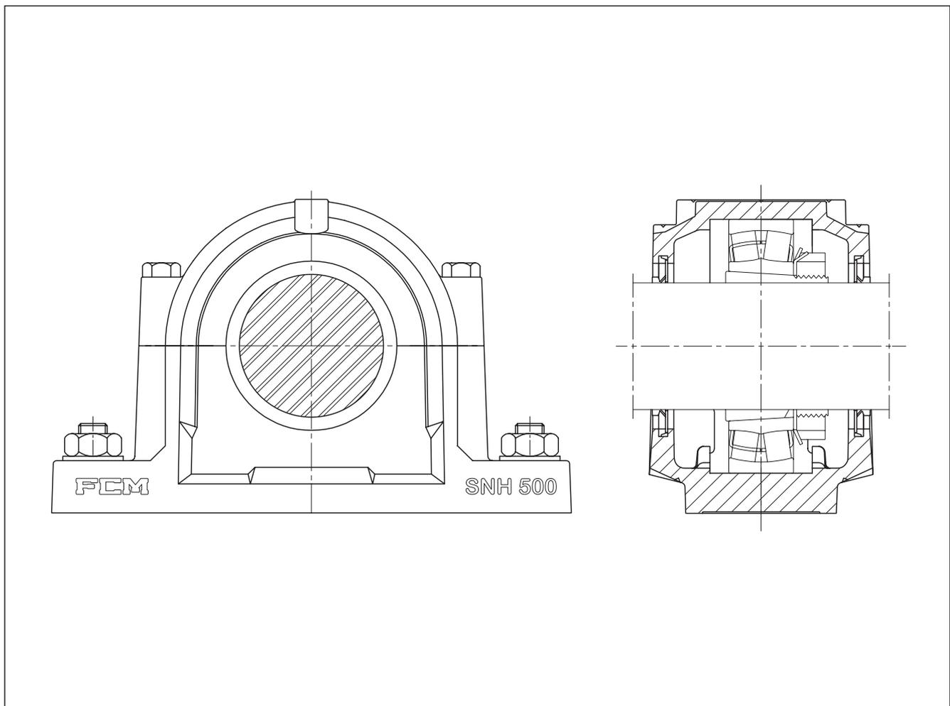
a caixa comporta. O rolamento que vai guiar o eixo (lado fixo), deve ser fixado axialmente por meio de anéis de bloqueio (normalmente deve-se especificar apenas um mancal guia por eixo). Os anéis de bloqueio para cada série de rolamentos estão especificados nas tabelas dimensionais e devem ser solicitados a parte.
